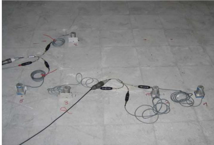
Abbildung 7: Schwinggeschwindigkeitsaufnehmer
