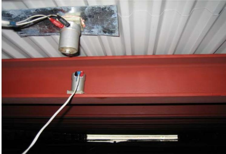
Abbildung 9: Messensoren (Stahlträger, Trapezblech)
