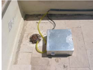
b) Installation der Sensoren und der zentralen Akquisitionseinheit im/auf dem Gebäude
